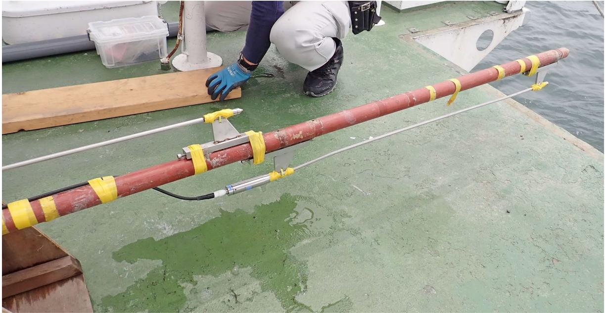
図1 湖底での熱流量測定に用いた装置のプローブ部分。
