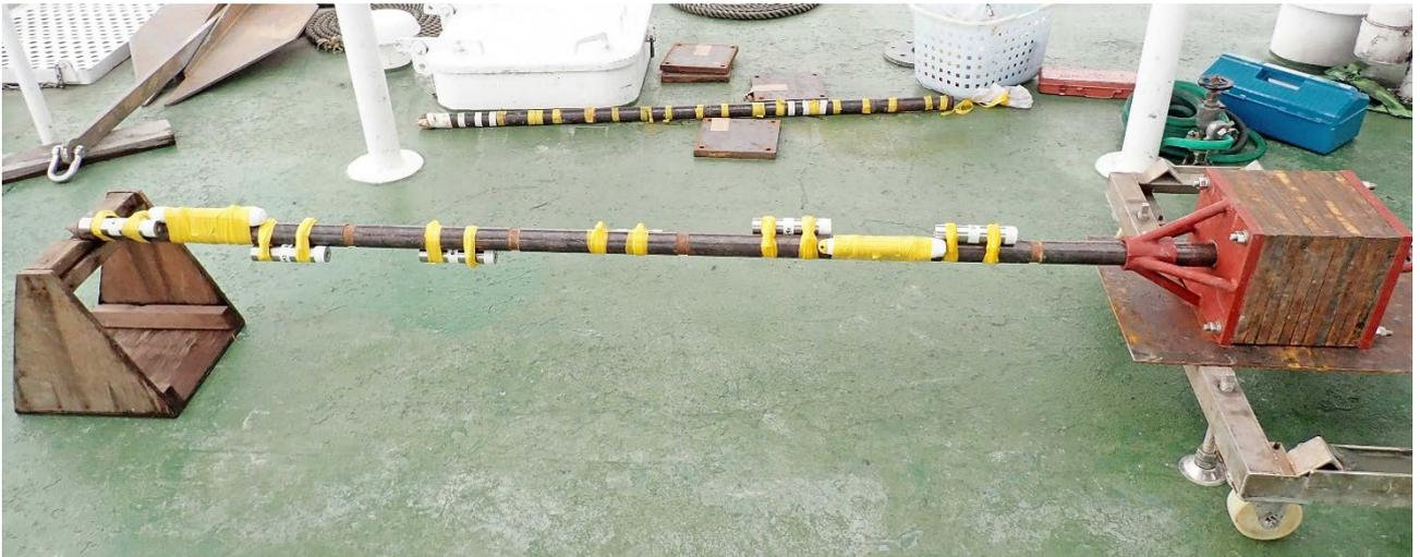
図5 堆積物中の温度分布の長期計測に用いた装置。
