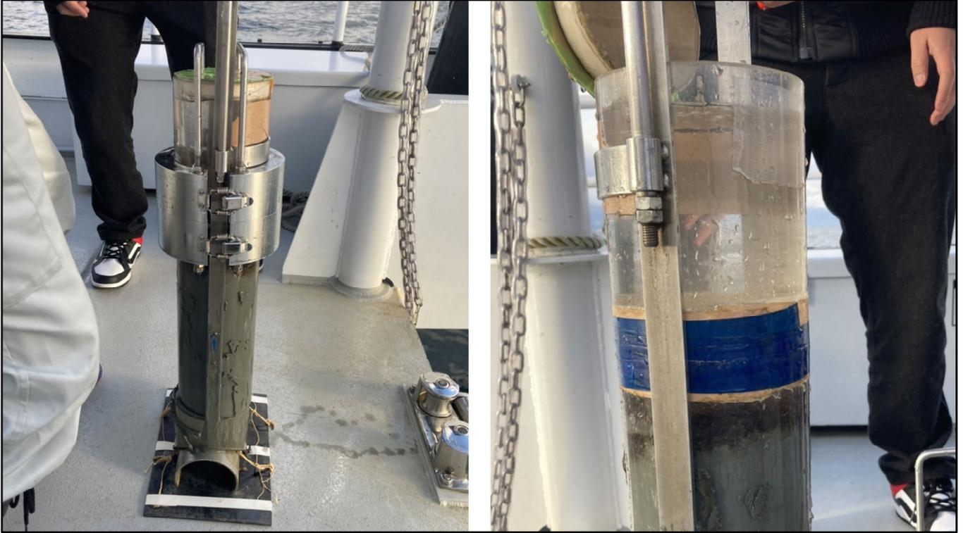
図3 2021年12月2日の深部湧水地点Y1での湖底泥の採泥の様子と上澄みの水。採泥直後の写真が左図で上澄みの水の部分を拡大した写真が右図。
