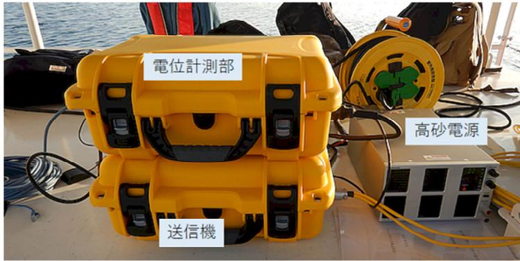
図8 電気探査用の機器.
