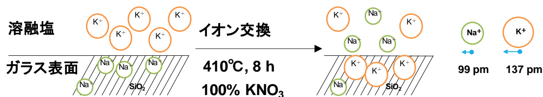
図 1-5 化学強化(イオン交換)のイメージ図
