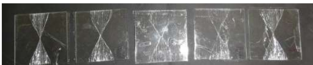
図 2-16 9.8 N のビッカース圧子圧入後に強化した試験片 (SLS) の強度試験後の写真
