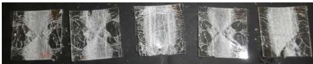
図 2-17 9.8 N のビッカース圧子圧入後に強化した試験片 (ALS-1) の強度試験後の写真
