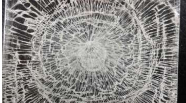
図 2-21 ROR 試験で破壊した試験片の例
