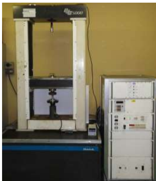
図 2-3 4点曲げ試験に用いた万能試験機
