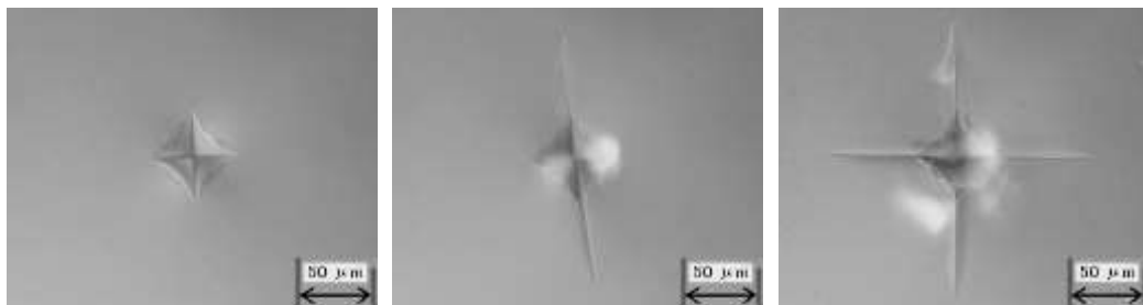
図 2-1 クラック発生率 0%(左、ALBS)、50%(中央、ALBS)、100%(右、SLS); 圧子圧入荷重は 9.8 N
