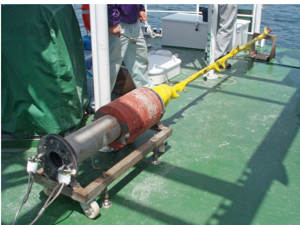
図1 「はっけん号」船上の熱流量測定装置。プロープ長3 mのもの。
