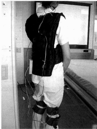
写真2 製作した姿勢計測センサを装着した様子
